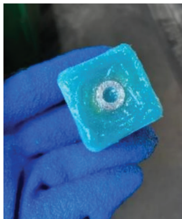
Figura: Instalação de DynaLogger com fixação por cola
