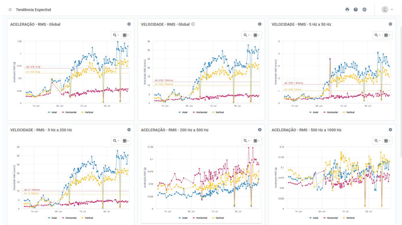
Figura: Gráficos de tendência espectral em diferentes bandas e métricas
