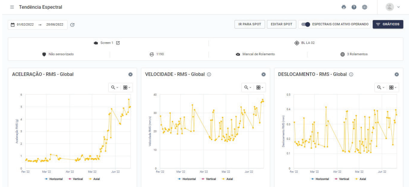
Figura: Tendência espectral padrão com gráficos de aceleração, velocidade e deslocamento
