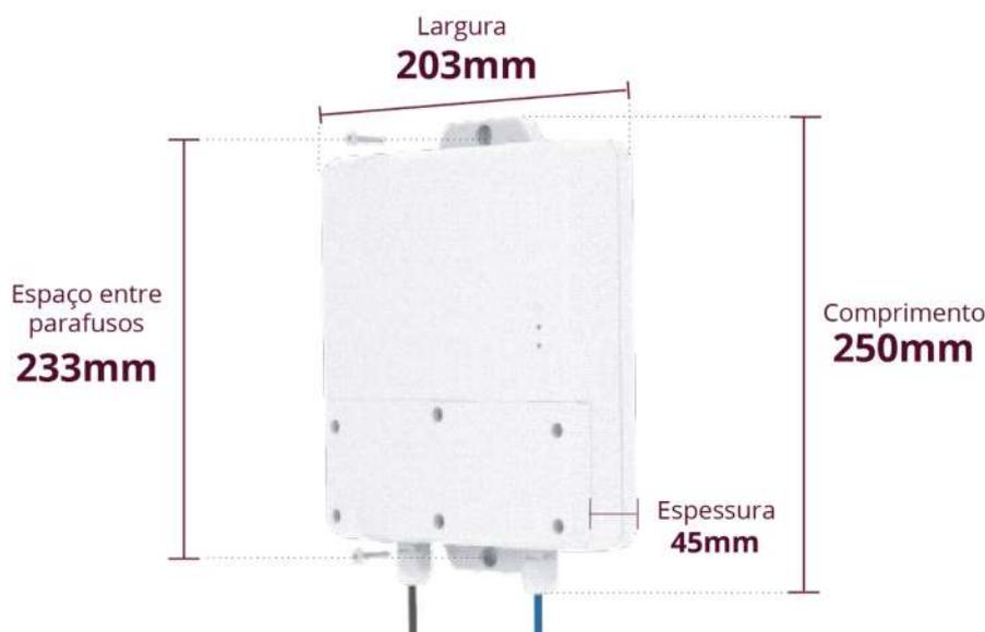
Para acessar as interfaces físicas do produto (porta USB, conexão RJ45, etc), é necessário desparafusar a tampa inferior frontal. É válido ressaltar que o torque de aperto desse componente deve ser de aproximadamente 3 N.m, considerando a dimensão do parafuso e o material de fabricação da carcaça.
