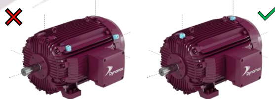
Não é recomendada a instalação em aletas e tampas. Obs: Para motores, a recomendação é instalar um sensor no lado acoplado e outro no lado oposto ao acoplado para um completo monitoramento.
